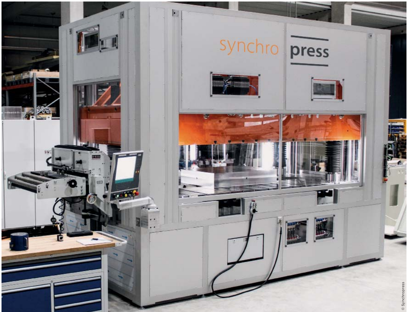
Eine für (fast) alles: Die synchropress-Technologie ermöglicht es Anwendern, eine Anlage als Entwicklungs-, Tryout- und Produktionspresse einzusetzen.
