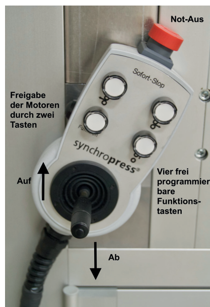
Bild 5: Joystick zum Verfahren des Stößels (Werkbilder: synchropress GmbH, Hövelhof)
