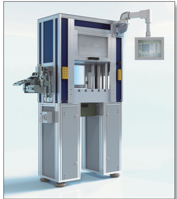
Bild 4: synchropress® 1M-80 – einmotoriger Antrieb mit 80 kN Presskraft – max. Geschwindigkeit 80 mm/sec.
